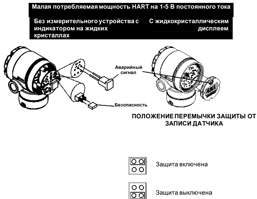
Рисунок 2-13. Электронные платы датчика с малой потребляемой мощностью.
