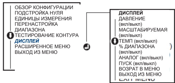
Рис. 2-12. Конфигурирование дисплея с помощью локального интерфейса оператора
