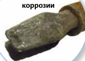
Вилка со следами коррозии
