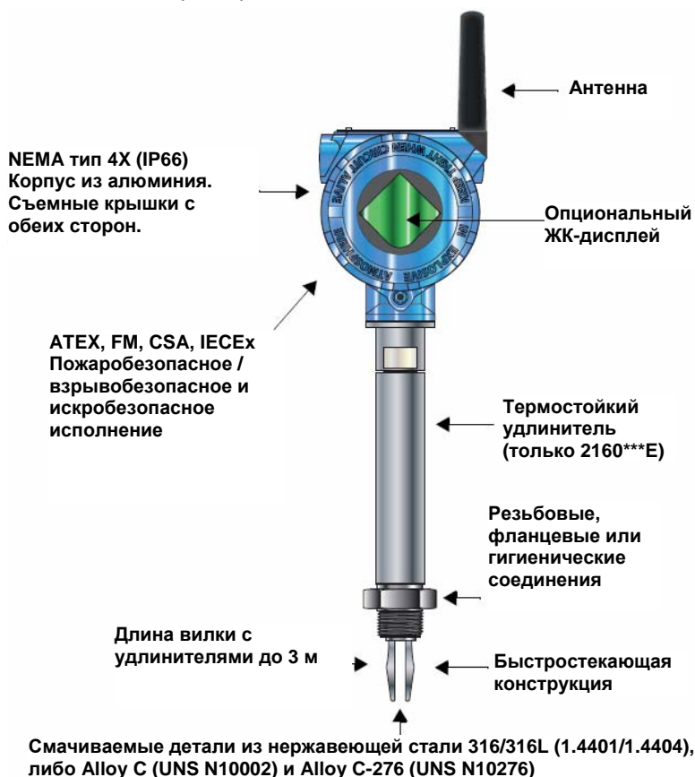
Рисунок 1-1. Функциональные элементы сигнализатора серии 2160
