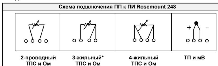
\* Компания Rosemount Inc. предоставляет 4-жильные ПП для всех отдельных элементов ТПС. Данные ТПС можно использовать и в трехжильных конфигурациях, оставив ненужные провода неприсоединенными и изолировав их лентой.
