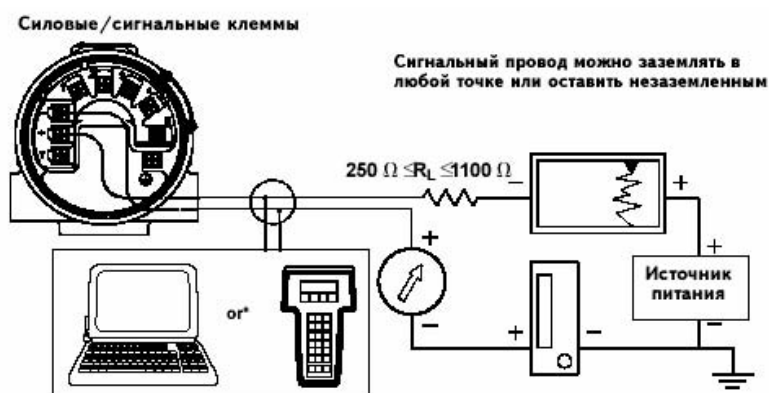
Рисунок 2-10. Соединение коммуникатора с сигнальной петлей датчика (HART /4-20 мА)
