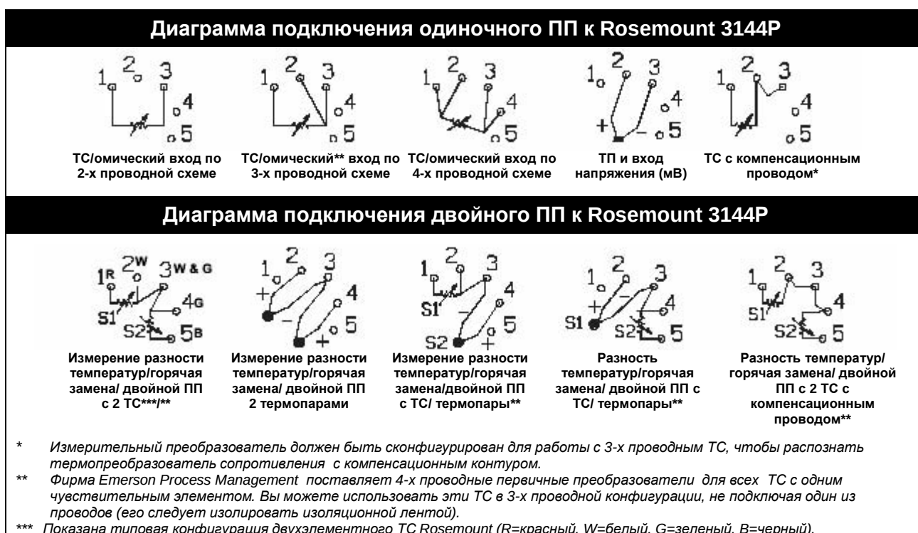
Рисунок 2-9. Схема подключения первичных преобразователей HART / 4-20 мА
