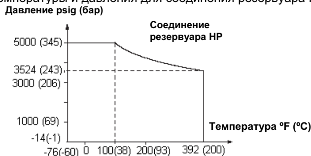
Рисунок А-3. Диаграмма температуры и давления для соединения резервуара HP
