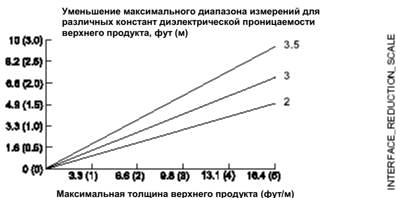
Рис. 2-7. Уменьшение максимального диапазона измерений для двухпроводного гибкого зонда.
