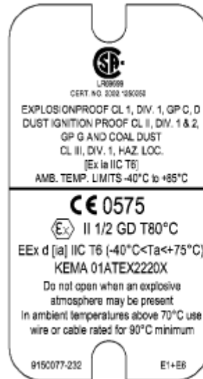
Рисунок В-6. Сертификационная табличка взрывозащиты АTEX и Канадской Ассоциации по Стандартам (CSA)
