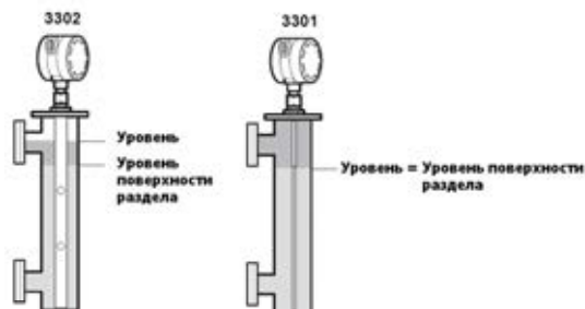
Измерение уровня границы раздела сред с помощью Rosemount 3302 и Rosemount 3301(зонд полностью погружен)
