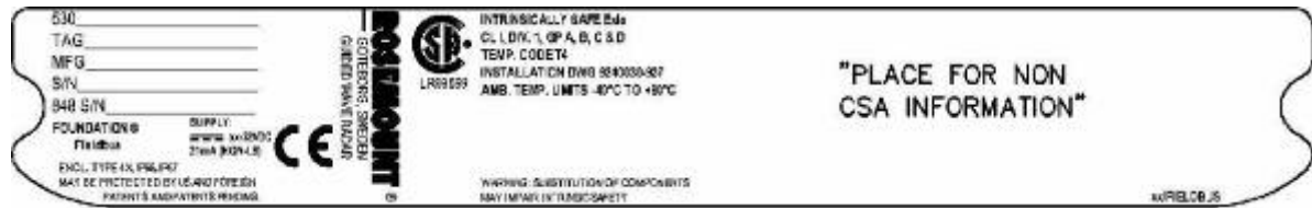
Рис. В-15. Шильдик уровнемера, с сертификацией CSA, с выходным сигналом Foundation Fieldbus
