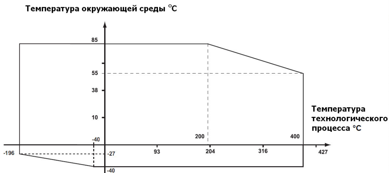
Рис. 3-9. Зависимость температуры окружающей среды от температуры технологического процесса (в ёмкости).
