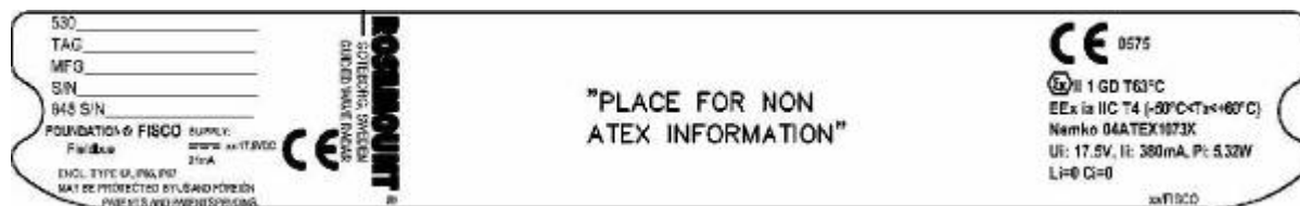
Рис. В-3. Шильдик уровнемера, с сертификацией ATEX FISCO, с выходным сигналом FF
