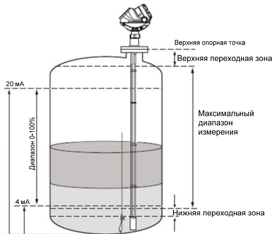
Табл. 2-2. Переходные зоны для различных типов зондов и диэлектрических постоянных
