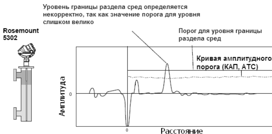
Рис. 6-6. Уровнемер определяет эхо-сигнал от уровня границы раздела сред как эхо-сигнал от уровня верхней среды.
