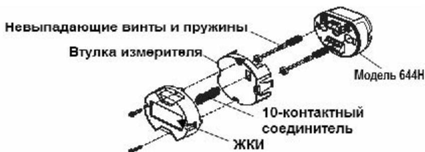
Для установки измерителя выполните следующую процедуру:
