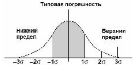
Указанные в технических характеристиках пределы составляют  $\pm 0.15^\circ\text{C}$ , но в соответствии с затемненной областью на рисунке, примерно 68% приборов имеют характеристики, превосходящие эти пределы в три раза. Поэтому, вполне вероятно, что Вы будете эксплуатировать приборы, имеющие лучшие характеристики по сравнению с указанными стандартно.
