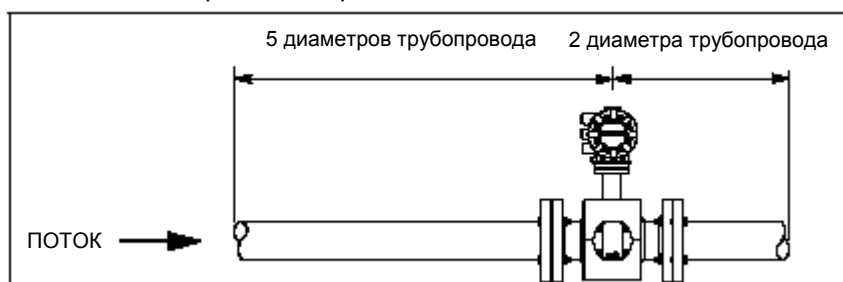
Рисунок 5-2. Участок трубопровода до и после расходомера
