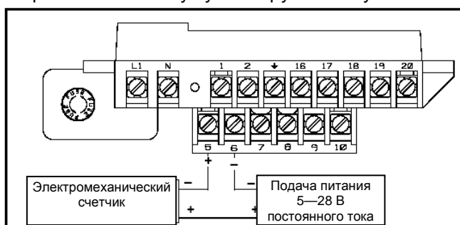
Рисунок 2-8. Подключение к электронному сумматору/счетчику без встроенного источника питания
