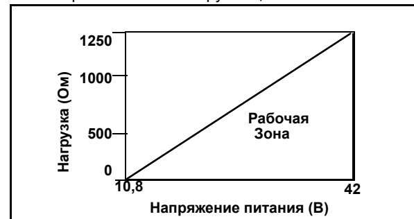
Рис. 7. Ограничения по нагрузке цепи постоянного тока
