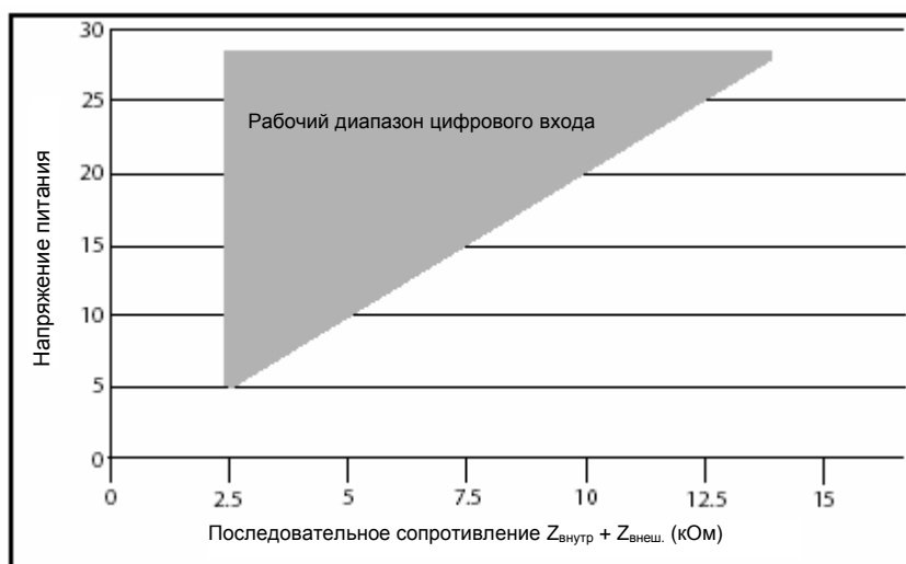
Рисунок 2-13. Рабочий диапазон цифрового входа
