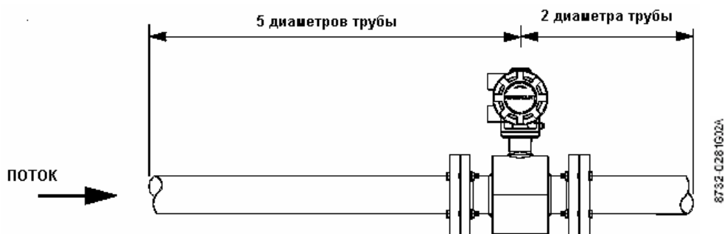
Рисунок 5-2. Диаметры прямолинейного участка трубы до и после потока
