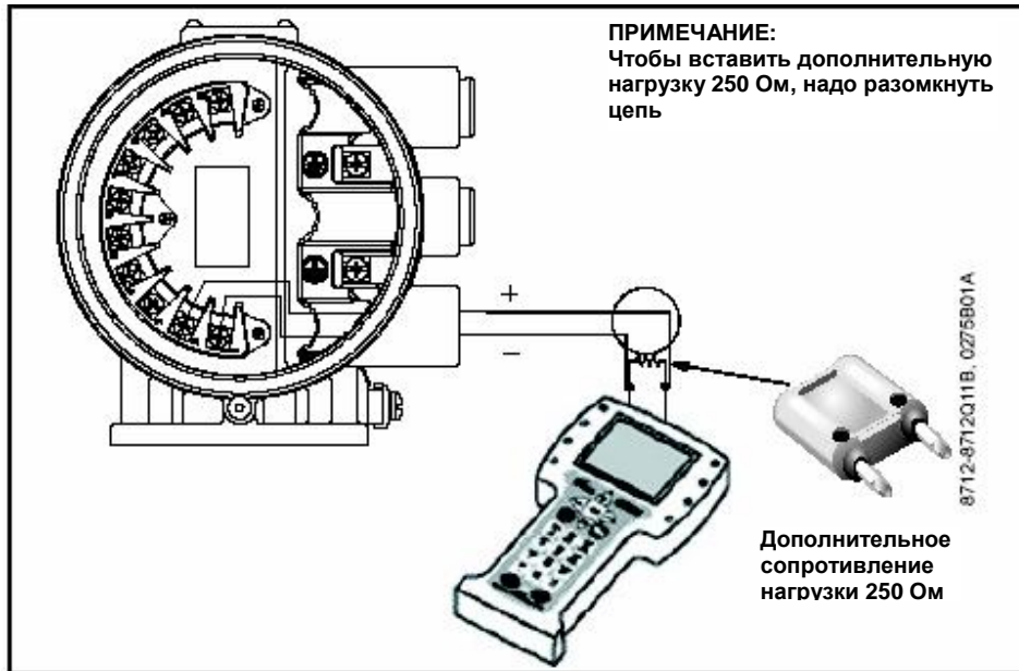
Рисунок F-4. Соединение коммуникатора с дополнительным сопротивлением нагрузки
