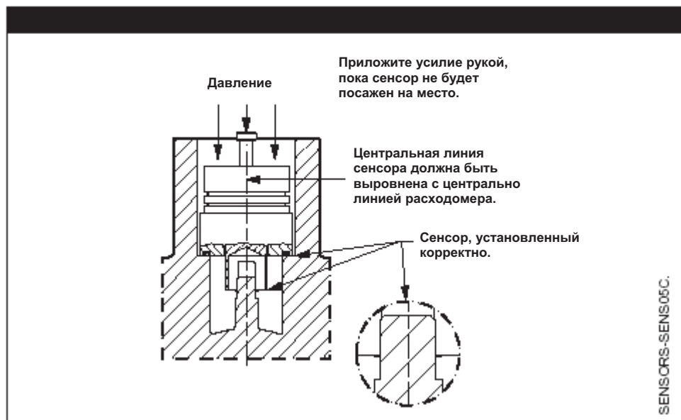
Рисунок 5-15. Установка сенсора – приложение усилий
