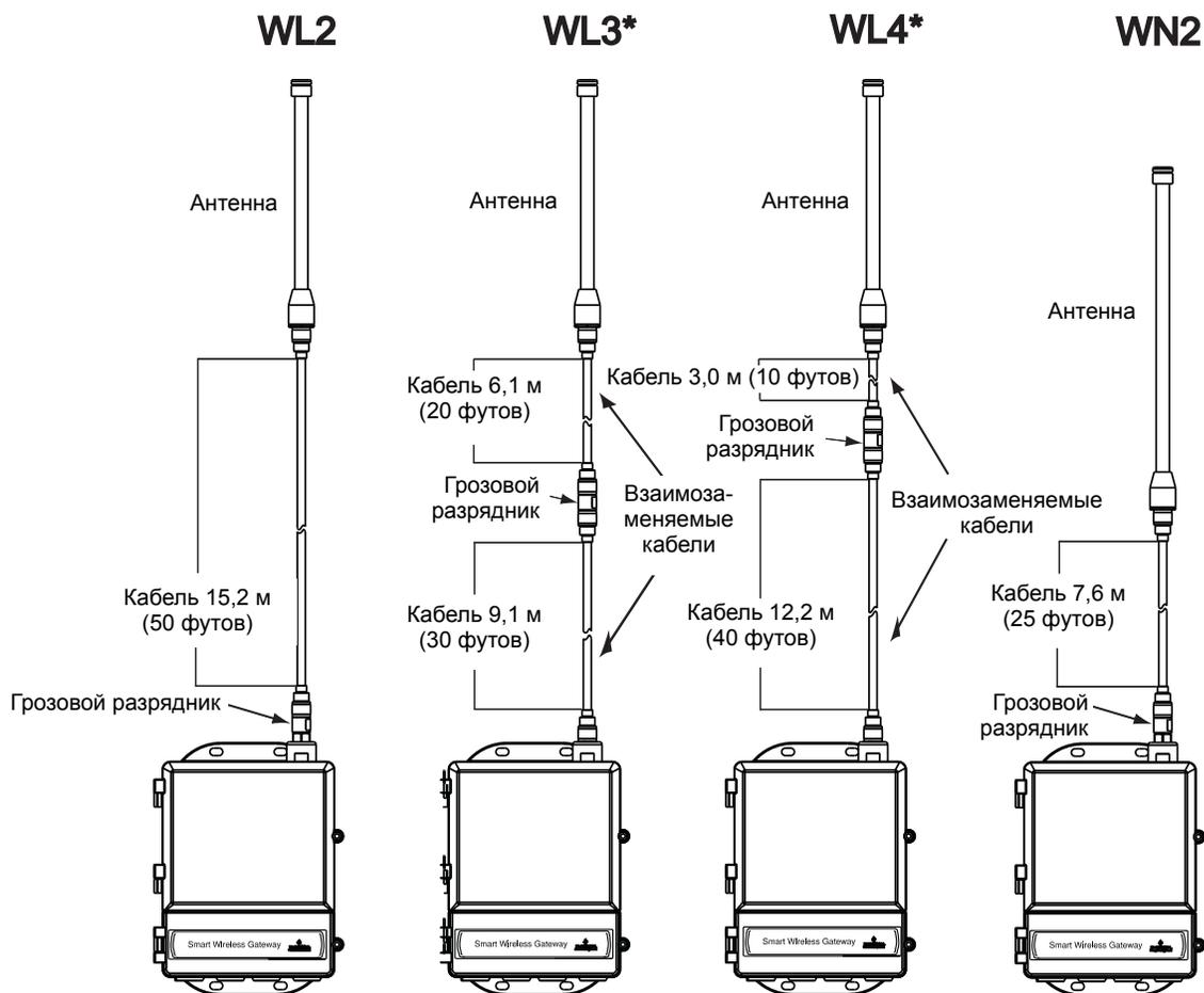
В комплект выносной антенны включена уплотнительная лента для подключения выносной антенны, а также монтажные кронштейны, грозовой разрядник и шлюз Smart Wireless.
