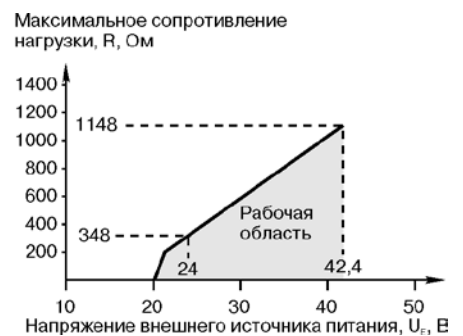
Рис. 22. Диаграмма сопротивлений для уровнемера, сертифицированного на взрывобезопасность.
