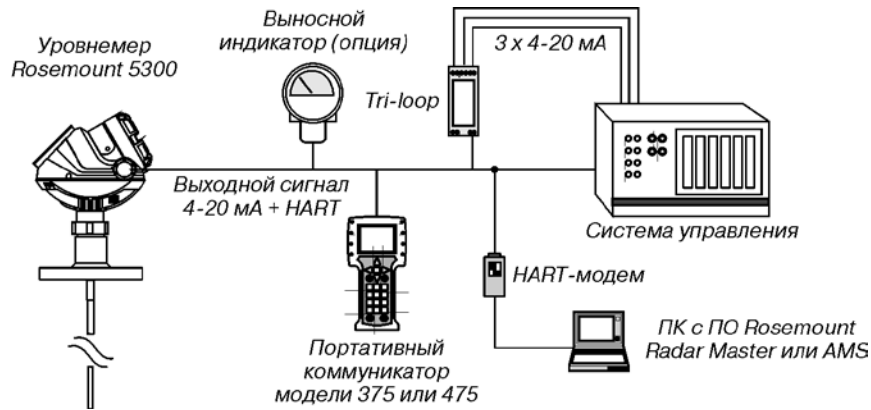
Рис.23. Интеграция в систему с использованием HART-протокола.
