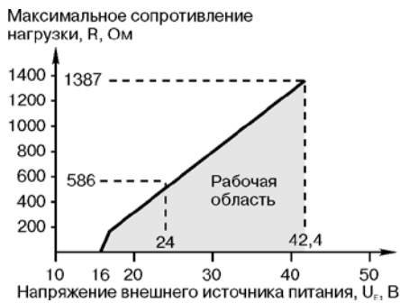
Рис. 15. Диаграмма сопротивлений для уровнемера в безопасной зоне.
