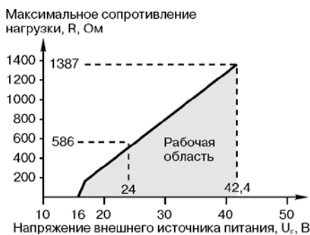
Рис. 20. Диаграмма сопротивлений для уровнемера в безопасной зоне.
